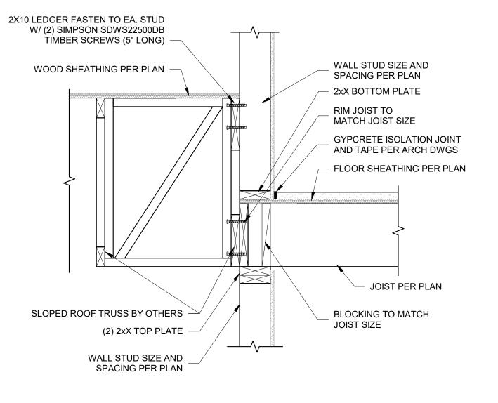
4 ROOF DRAG TRUSS SECTION AT SHEAR WALL
