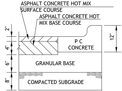
ASPHALT CONCRETE HOT MIX
